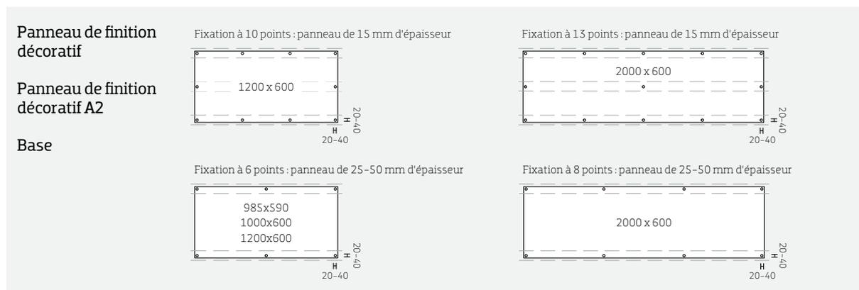
■ 7.3 QUADRILLAGE DE FIXATION
