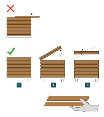
Les mesures de précaution suivantes doivent être prises lorsque vous allez monter des panneaux Heraklith® colorés :
